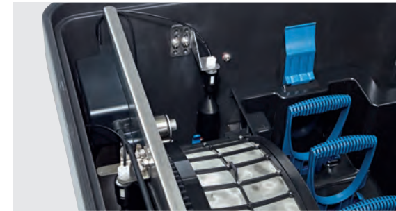
Clevere Trommelfiltertechnik: Der innovative und selbstreinigende Vorabscheider trennt zuverlässig Wasser und feste Partikel bis zu 125 Micron. Und das ohne zusätzlichen Reinigungsaufwand.
