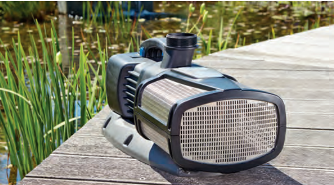
Robuster Filterkorb: Durch diesen robusten Filterkorb aus Edelstahl werden Grobschmutzpartikel von bis zu 4 mm Größe problemlos gefördert.
