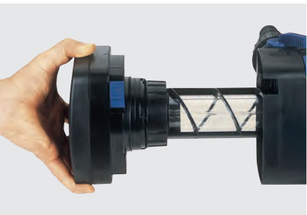
Verschluss technik: Schnellverschluss zum leichten Öffnen des Lampengehäuses. Ein Sicherheitsschalter deaktiviert die UVC-Lampe hierbei automatisch zum Schutz vor Augenschädigung.
