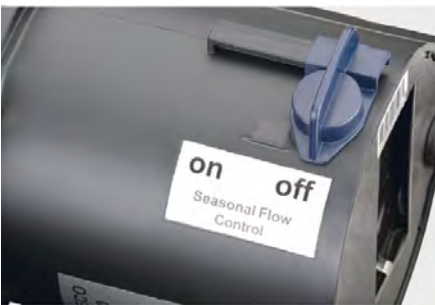
SFC-Schalter: Bei AquaMax Eco Premium 12000 / 16000 / 20000. Bei eingeschalteter SFC-Funktion optimiert die Pumpe selbstständig Wassermenge und Förderhöhe und reduziert diese um bis zu 50 %.
